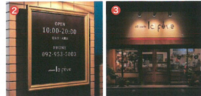
①ステンレス切り文字のロゴは、スポットライトで印象的かつ上品に ②木製のフレームを手作業で塗装し、雰囲気のあるアンティーク調に ③ドア下部のキックプレートは真ちゅう製にし、お店全体の印象に統一感を出しました。
